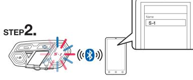
Accendere il bluetooth del cellulare, scegliere S-1, l'accoppiamento è completato. Un messaggio vocale ci dice che l'accoppiamento è completato
