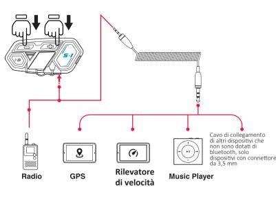
S-1 è equipaggiato con cavi di connessione in modo da connettere apparecchi senza bluetooth
